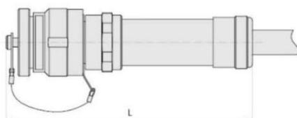
注：直式尾附，可固定混合缆，内置压板夹紧混合缆和屏蔽网，实现屏蔽。
