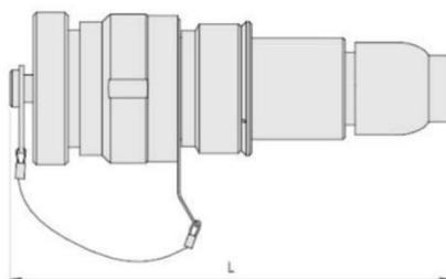
注：通过Ti-Ni合金记忆环固定屏蔽网，真正实现360°电磁屏蔽，该附件不能应用与抗拉力大的环境中。
